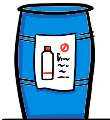
Un tambo de 200 litros puede servir como centro de acopio primario si se mantiene bien tapado. Se debe cuidar que no se depositen otro tipo de residuos. Fuente: Adaptado de Campo Limpio A.C.
