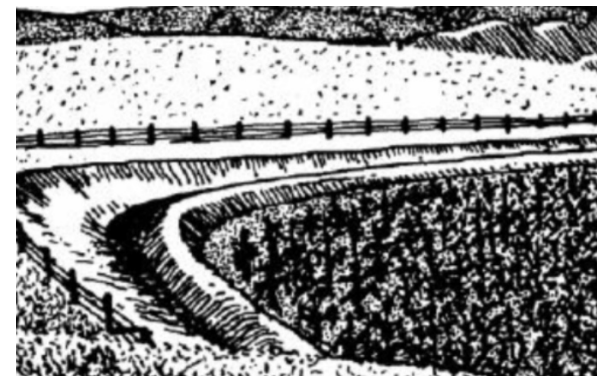
Canal de infiltración. Fuente: Asencios Pineda (2012).
