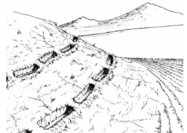
Zanja de infiltración. Fuente: Proyecto JALDA
